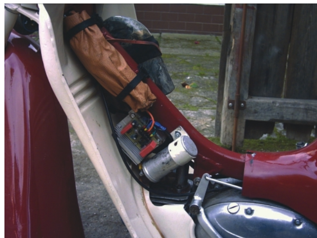
Obr. 5. Umístění zapalování v motocyklu Jawa Pionýr
